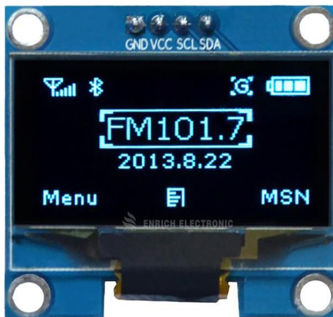
Рис. 2.6. 1.3-дюймовий I2C OLED SSD1306 екран із роздільною здатністю 128x64
