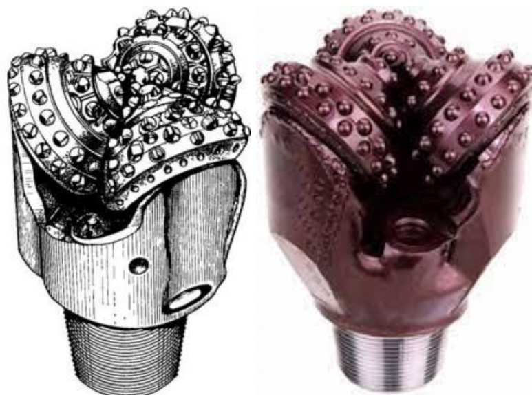
Рисунок 2.3. Схема виконання шарошкового долота
