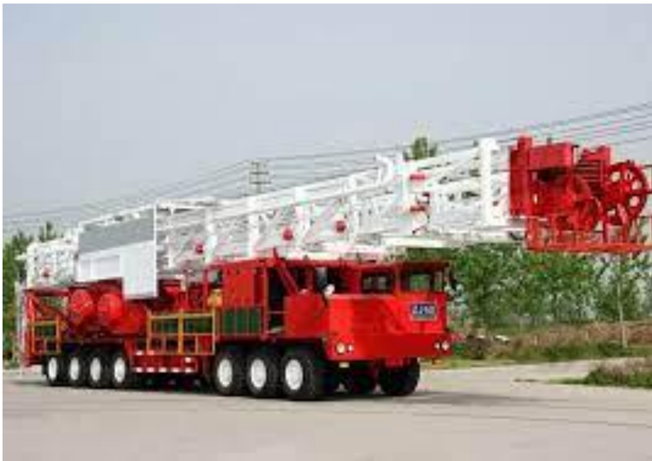
Рисунок 2.2 – Малогабаритна бурова установка ZJ-40
