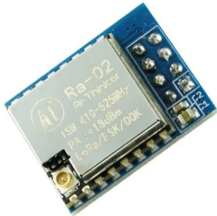
a) LoRa module (model SX1278)
