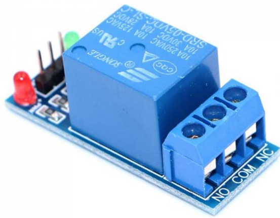
a) relay module: 5 V 10 A
