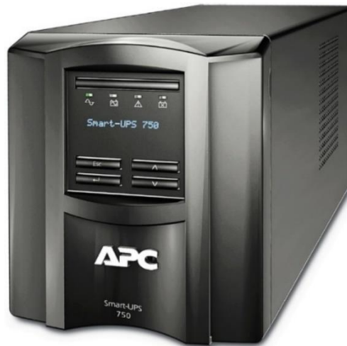
Рисунок 2.5 – Зовнішній вигляд джерела безперебійного живлення APC SMT750IC
