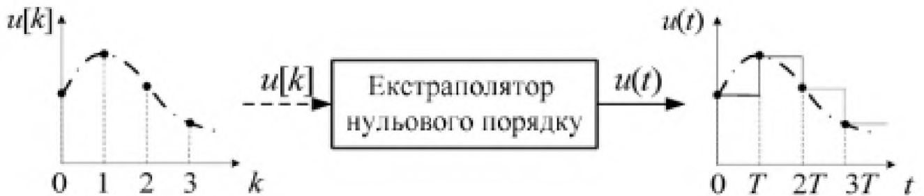
Рисунок 1.7 – Принцип роботи екстраполятора нульового порядку
