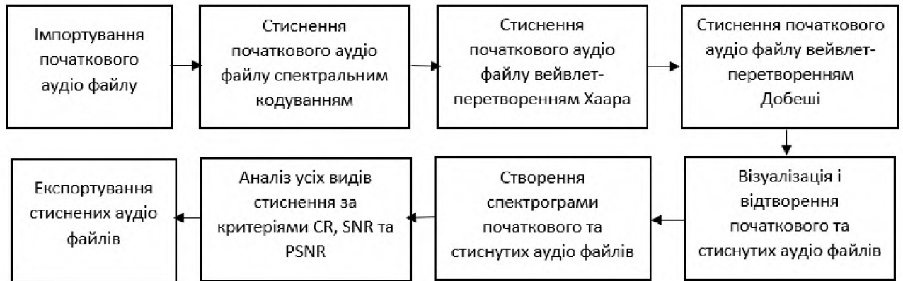
Рис. 2.3 Алгоритм програми стиснення
