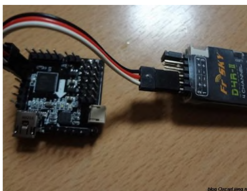
Рисунок 1.8 – Дротове з'єднання протоколу PPM
