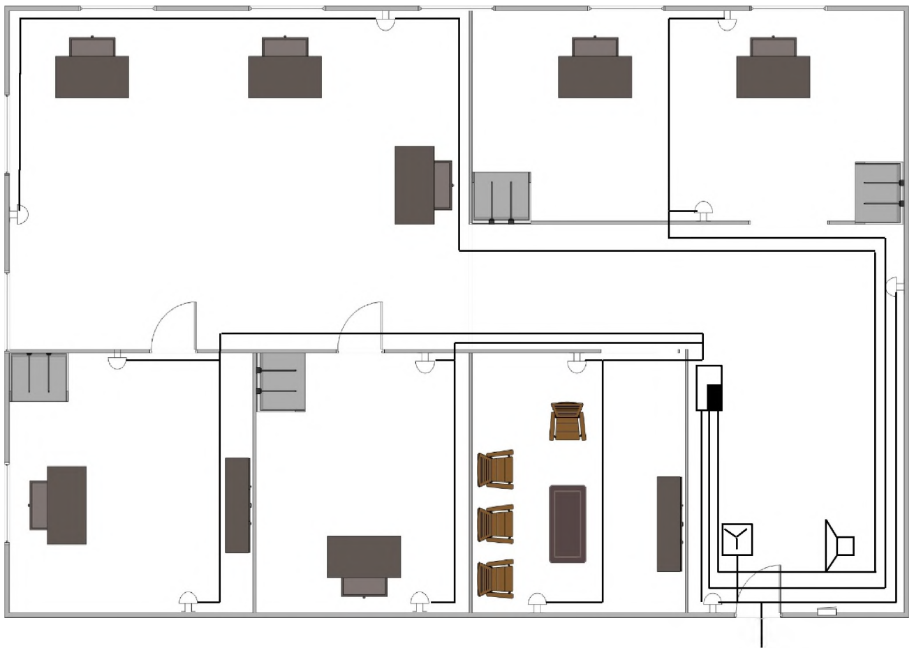
Рисунок 2.5 - Схема підключення пожежної охорони
