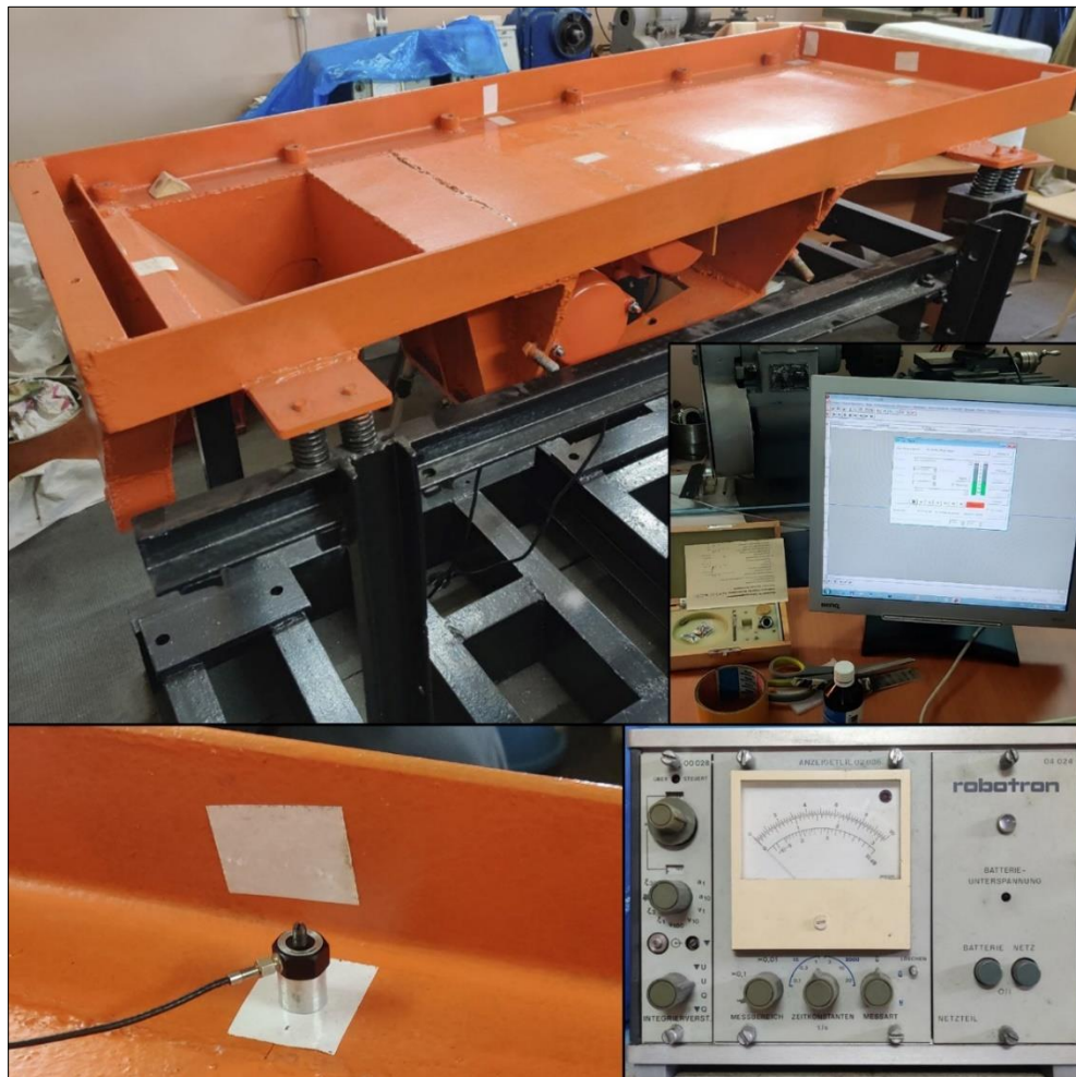
Рисунок 4.9 – Основні компоненти лабораторного станда для дослідження грохотів
