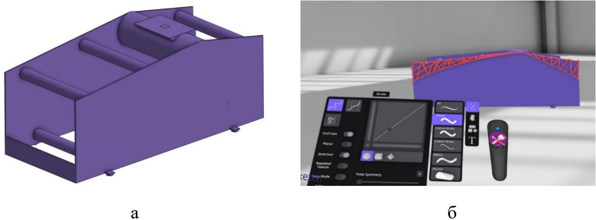
Рисунок 5.5 – Модель грохота: а – розроблена в SolidWorks на основі моделі Gravity Sketch; б – редагування моделі в Gravity Sketch
