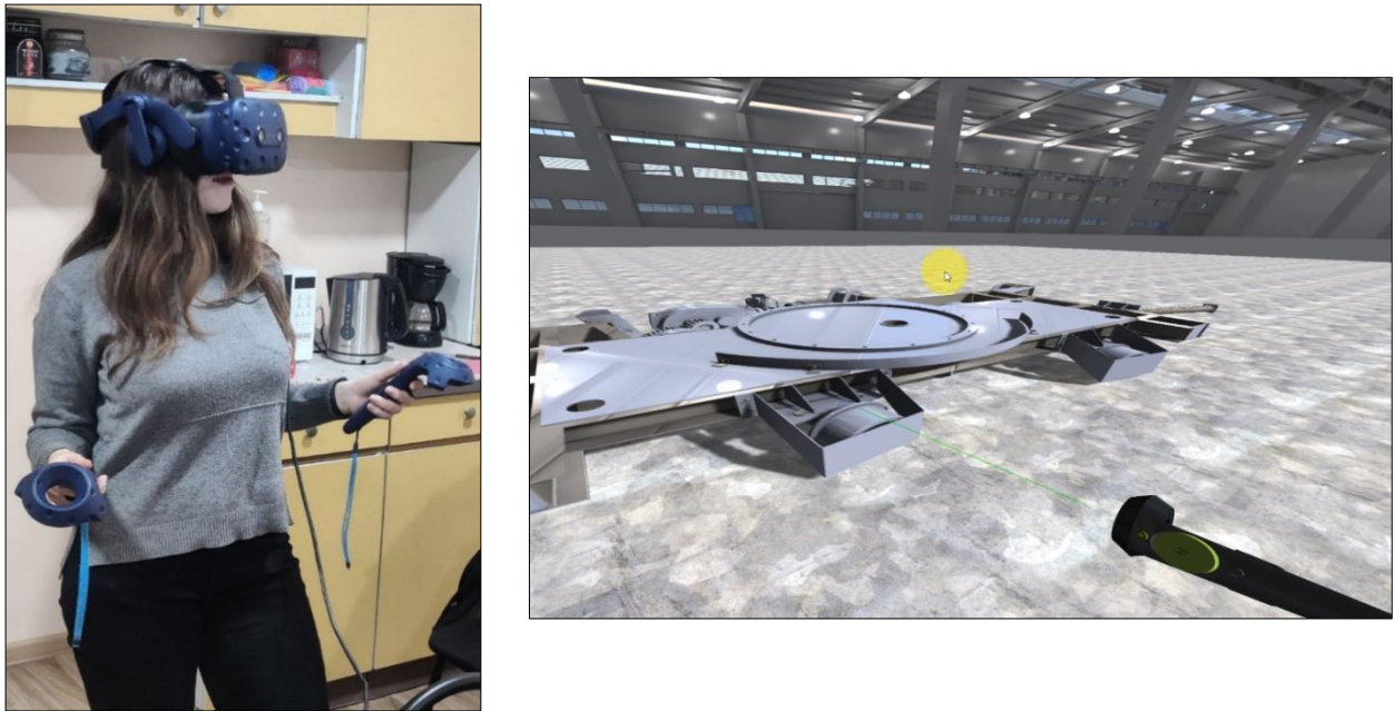
Рисунок 1.6 – Перегляд віртуальної моделі ходової частини машини опіковочно-завантажувальної МОЗ 2,5 через додаток EDrawing Джерело: архів кафедри інжинірингу та дизайну в машинобудуванні
