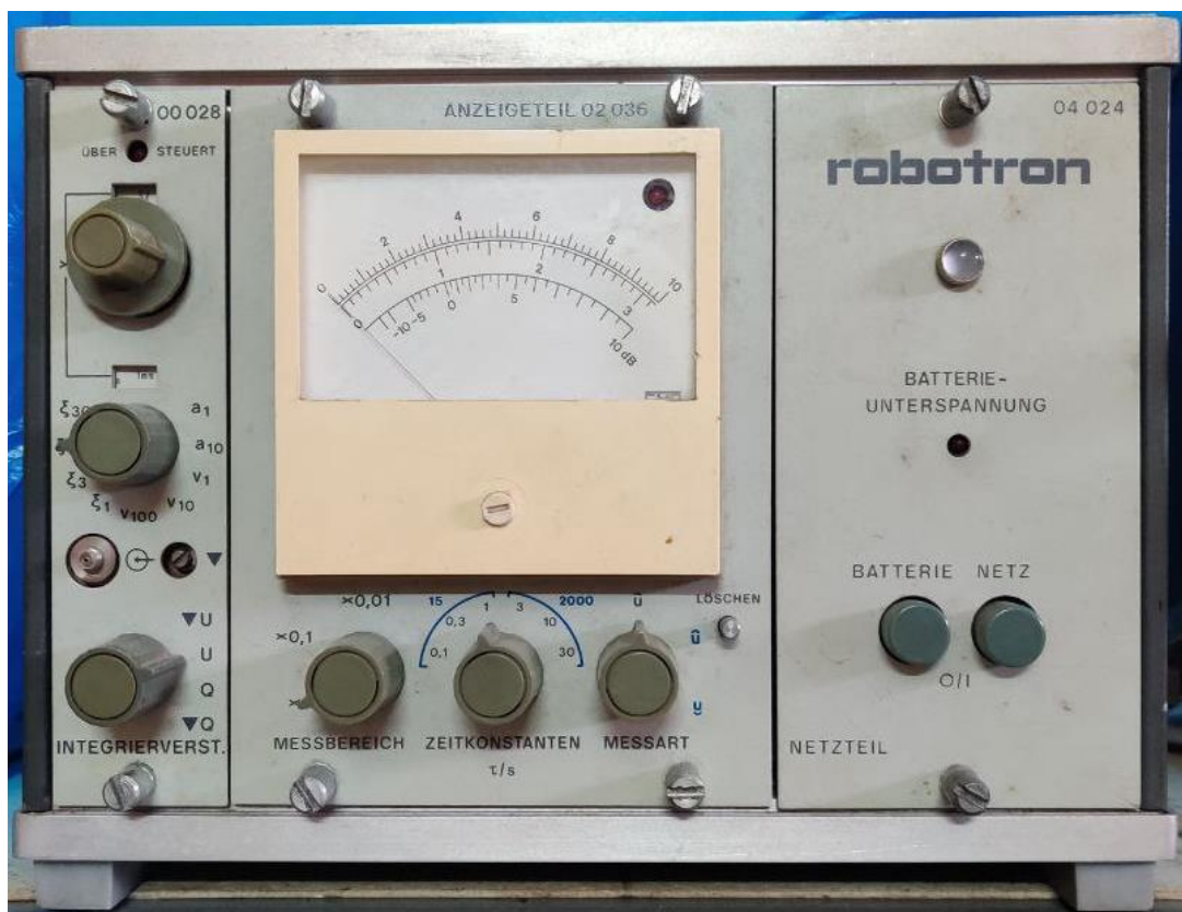
Рисунок Б1 – Фотографія віброметра 00032
