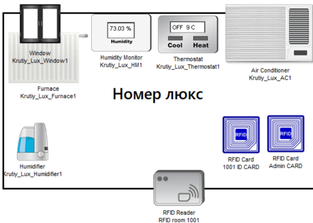
Рисунок 4.7 Схематичний приклад розміщення IoT- приладдя у номері класу “Люкс”
