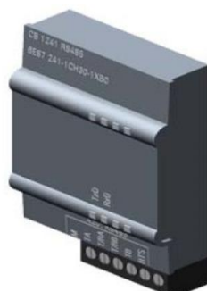
Рисунок 2.5 – Комунікаційна системна плата серії SIMATIC S7-1200, CB 1241 RS485
