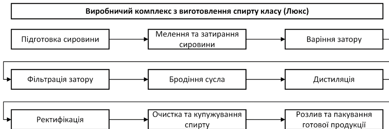
Рисунок 1.3 – Схема виробничого процесу
