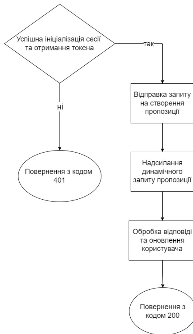
Рис. 3.4. Узагальнена схема роботи функції /user/profile/diia
