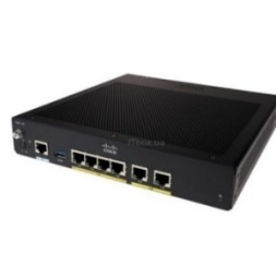
Рисунок 2.3 – Зовнішній вигляд маршрутизатора C921-4P
