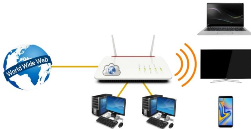
Рисунок 2.5 – Підключення через роутер власної домашньої локальної мережі до Інтернету
