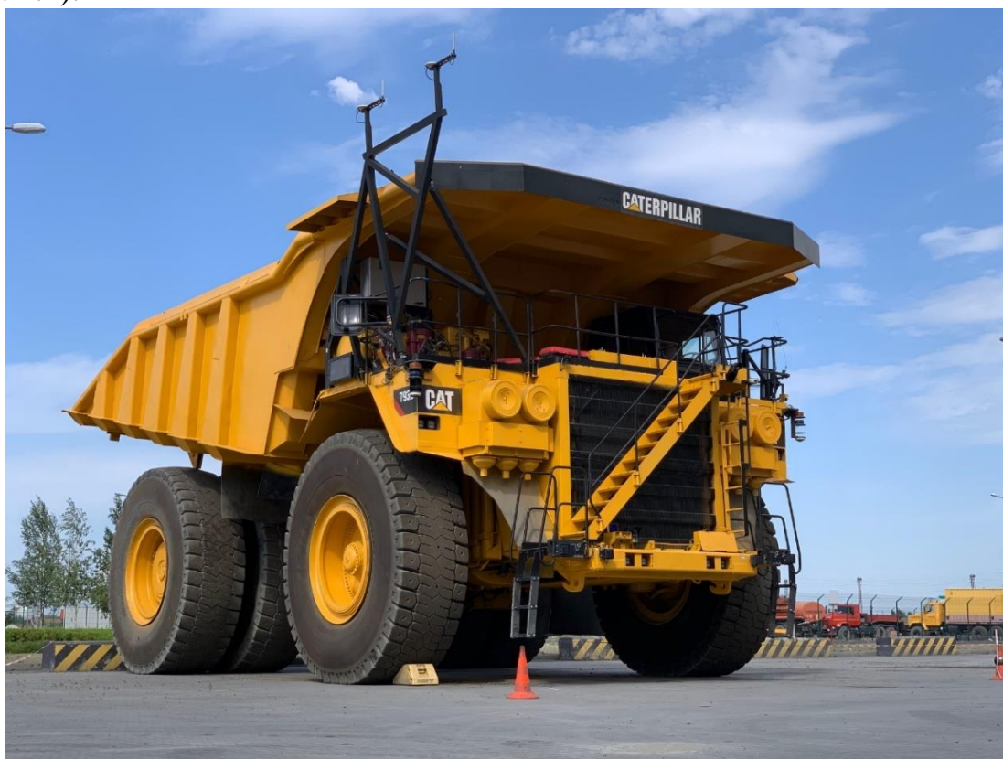
Рисунок 2.1. – автосамоскид CAT 793D з системою автоматизованого дистанційного керування
