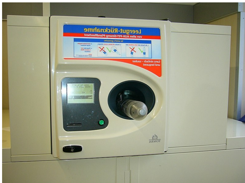
Рисунок 2.12 - Зворотний торговий автомат для порожніх банок напою і ПЕТ-пляшки в супермаркетах Aldi, Німеччина
