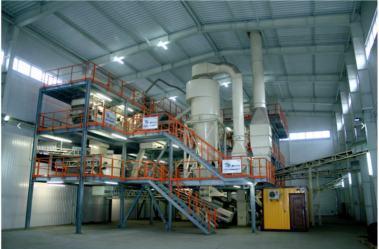
Рис. 1.8 – Сортивальні машини Redwave виробництва ВТ Wolfgang Binder
