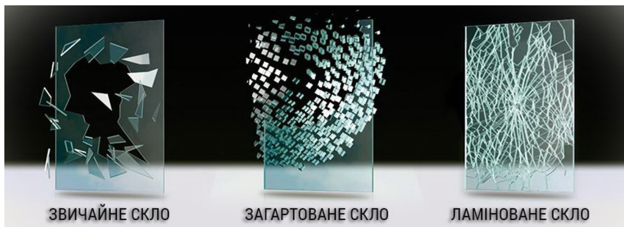
Рис. 2.2 – Звичайне, загартоване та ламіноване скло
