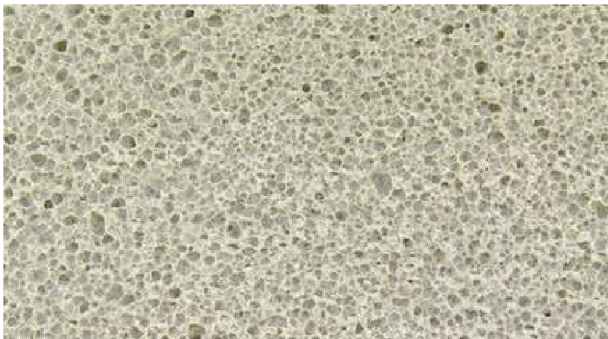
Рис. 2.5 – Структура бетонного каменю з додаванням подрібненого скла
