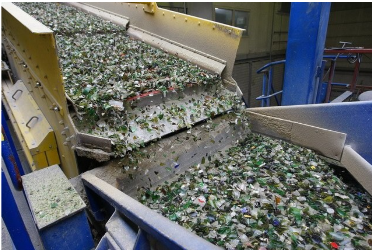
Рис. 2.3 – Вторинна переробка склобою
