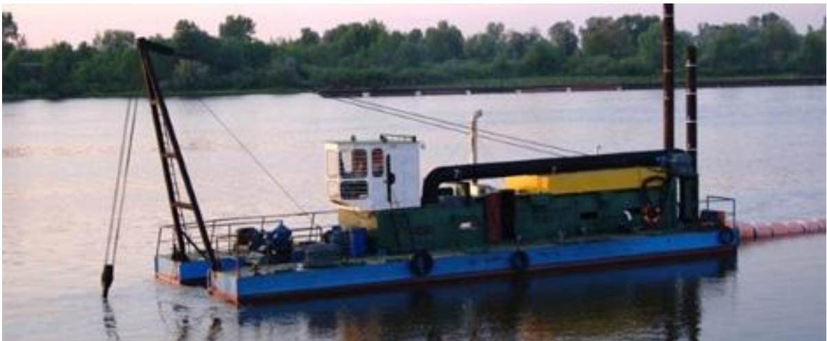
Рис. 3.1. Загальний вигляд земснаряда ЛС-27
