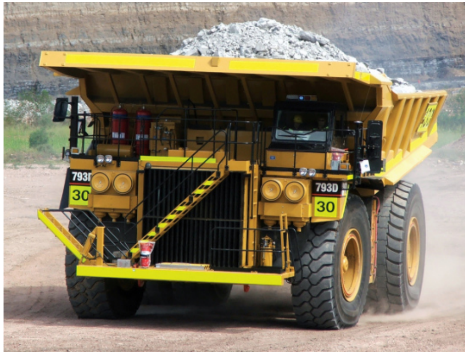
Рис. 3.1. Автосамоскид Cat 793 D при перевезенні гірничої маси
