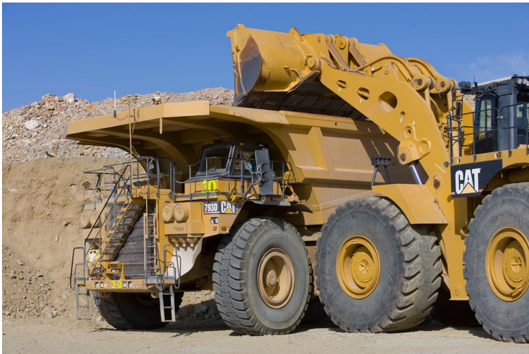
Рис. 3.1. Автосамоскид Cat 793 D при завантаженні гірничої маси навантажувачем
