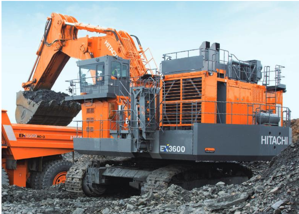
Рис. 2.3. Робота екскаватора EX-3600-5 на видобувних роботах
