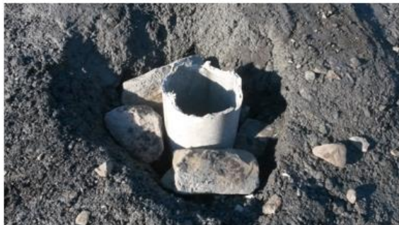
б) – гирло шарошечної свердловини обсаджено азбестовою трубою.
