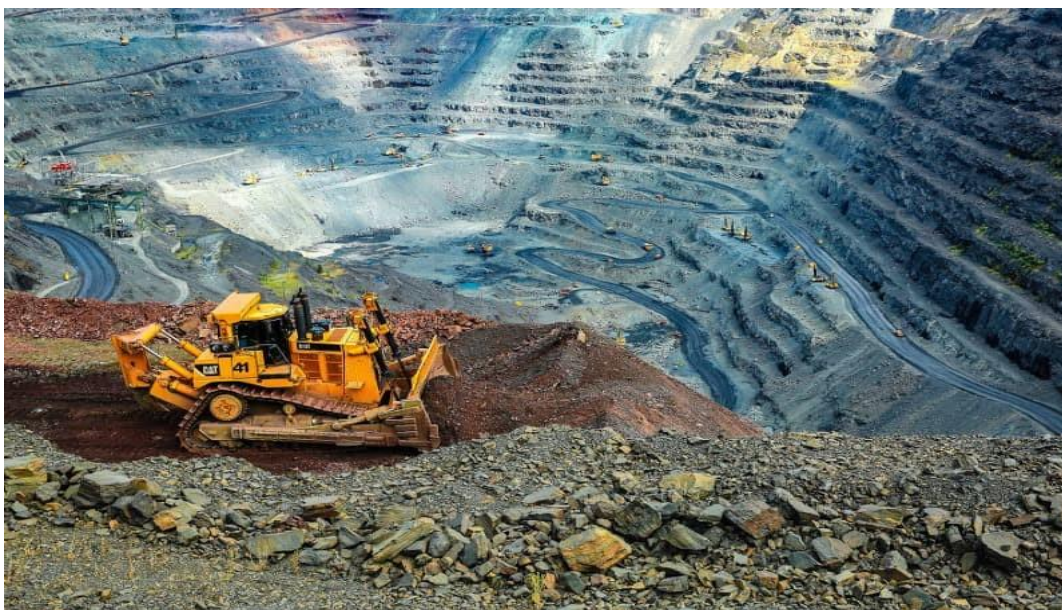
Рис. 3.1. Робота бульдозера Cat D8R на відвалі Полтавського ГЗК
