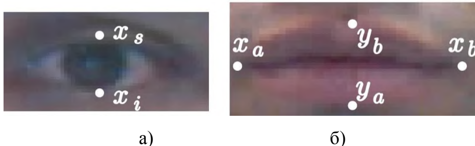
Рисунок 5.7 – Визначення розмірів очей і рота водія
