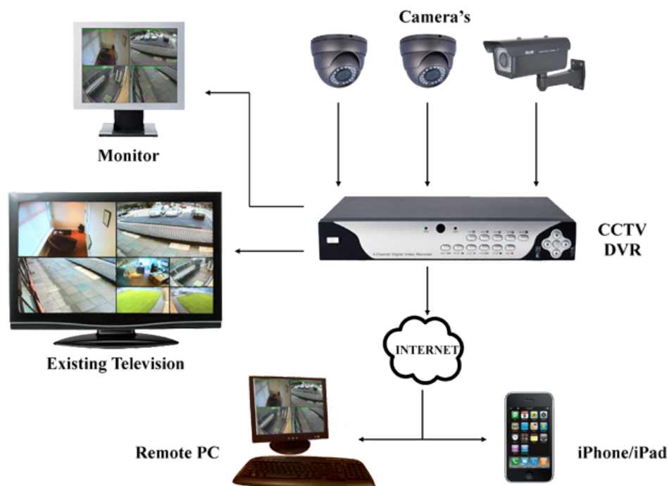
Рисунок 1.3 – Архітектура мережі аналогової камери CCTV
