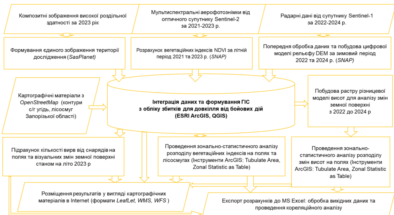
Рисунок 3.1 – Алгоритм оцінки збитків для довкілля від бойових дій на основі дистанційних методів
