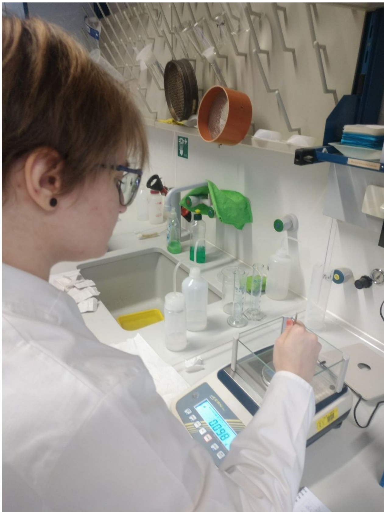
Рисунок 2.1 – процес зважування зразків за допомогою аналітичних ваг AS R2 «Radwag»
