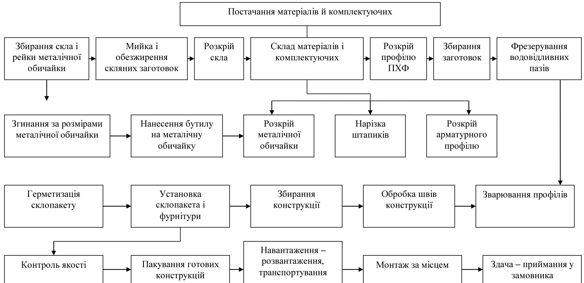
Рисунок 3.1 – Схема технологічного процесу виробництва металопластикових конструкцій у ПП «ЄВРО ГЛАС»
