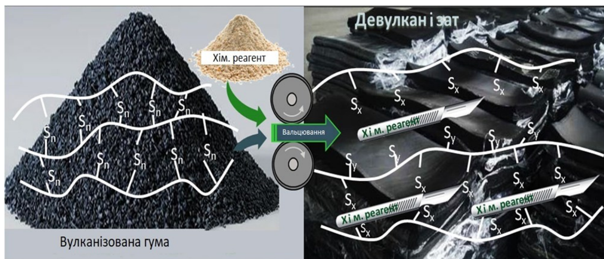
Рисунок 2.2 – Процес девулканізації гуми
