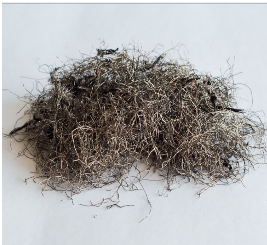
Рисунок 1.6 – Металокорд, який утворюється в результаті утилізації зношених автомобільних шин метолом піролізу
