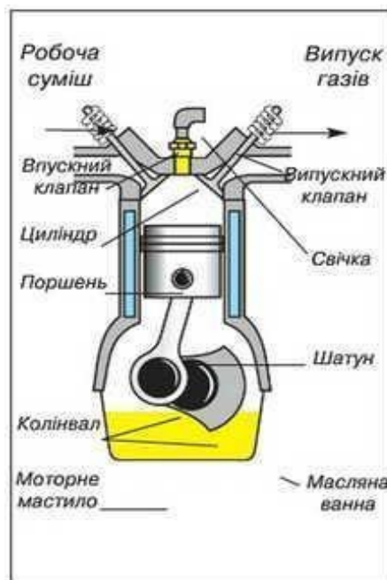
Мал.43. Будова 4-тактного двигуна
