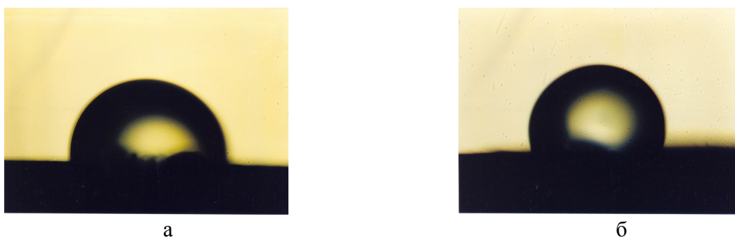
Рис. 2. Вид капли воды на поверхности брикета потонувшей фракции \theta_n = 88^\circ (а) и парафина \theta = 105^\circ (б)
