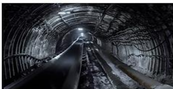
Рисунок 3.2 – Положення траси шахтового газопроводу в просторі гірничої виробки
