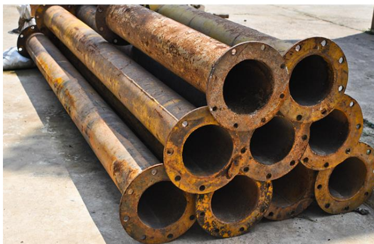
Рисунок 3.1 – Наслідки внутрішньої та поверхневої корозії металевих труб
