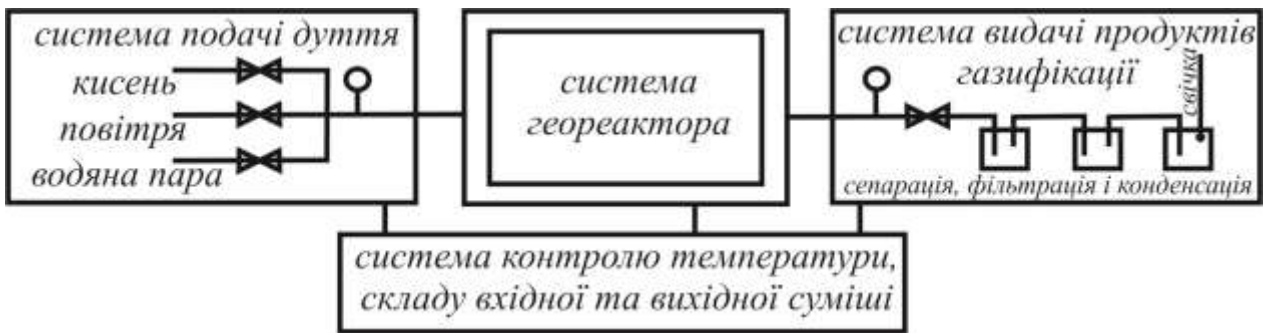
Рис. 4. Технологічна схема стендової установки підземної газифікації вугілля
