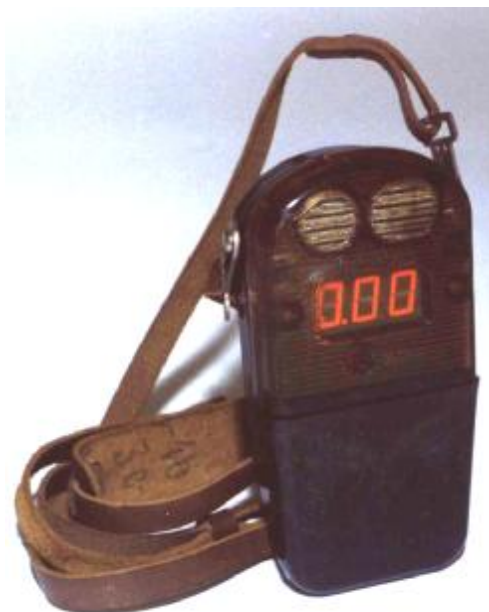
Рис. 7.10. Внешний вид анализатора метана переносного «Сигнал 9»
