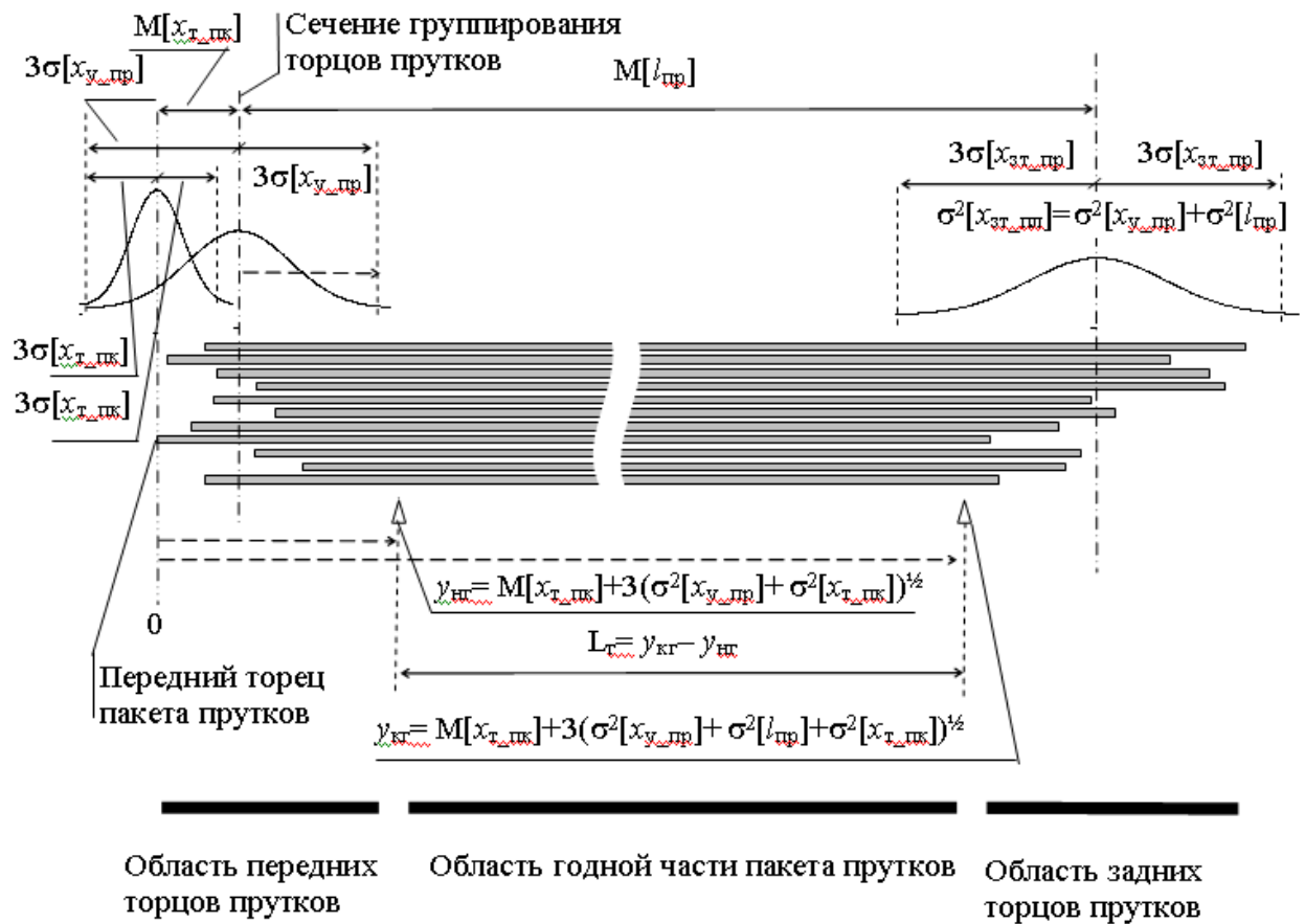
Рисунок 4.3– Конфігурація и статистичні характеристики пакета прутків дрібносортового прокату, укладених способом групування передніх торців: m[l_{пр}] , \sigma[l_{пр}] – м.о. и с.к.о. довжин прутків дрібносортового прокату; \sigma[x_{у\_пр}] – с.к.о. групуваного перерізу розташування прутків (передніх торців) відносно центру групування; m[x_{т\_пк}] , \sigma[x_{т\_пк}] – м.о. и с.к.о. розташування торця пакету відносно центру групування прутків; y_{нг} , y_{кг} , L_r – розрахункові координати розташування початку, кінця годної частини пакету и її довжина, відповідно, відносно переднього торця пакету
