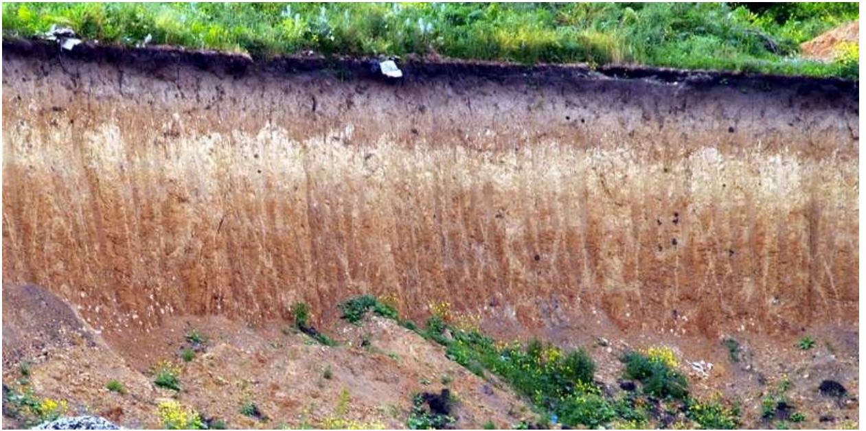
Рисунок 4.10 – Суглинки буро-коричневого і палево-жовтого кольору під чорноземом, вскриті на кар'єрі Шкільний
