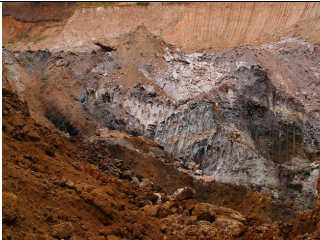
Рисунок 4.20 – Перехід масивних руд тіла №1 у густокріпленні і шлірові
