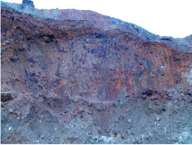
Рисунок 4.36 – Шлирова будова рудного тіла №1, розкритого на північному замиканні
