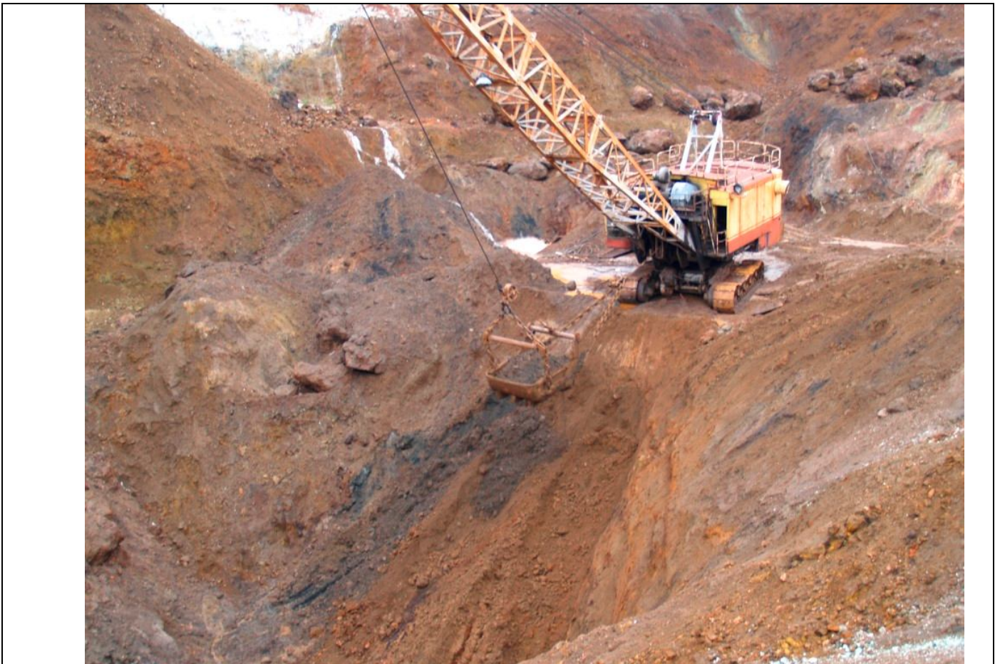
Рисунок 4.39 - зона хромітового зруденіння що відпрацьовується в кар'єрі Західний за допомогою екскаватора ЕКТ-5,5
