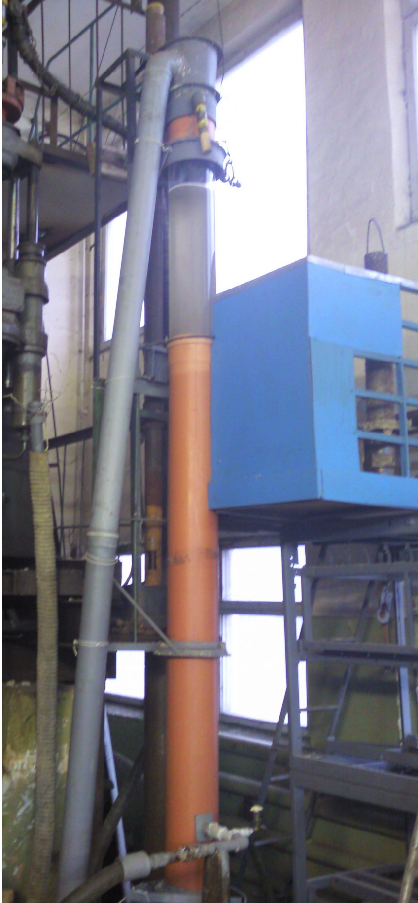
Рисунок 3.21 – Модель бурової свердловини, діаметр 200 мм
