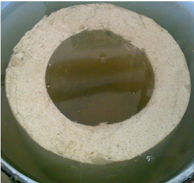
Рисунок 3.13 - Хїд експерименту: розтеплення у водї при початковїй температурї 17 0 С, концентрацїя желатину 10%
