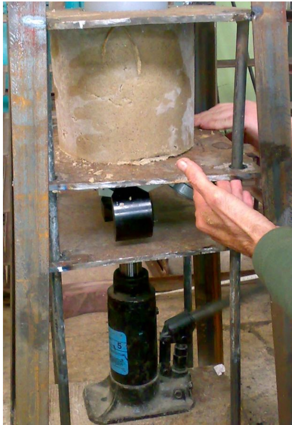
Рисунок 3.8 – Випробування КГЕ на стенді
