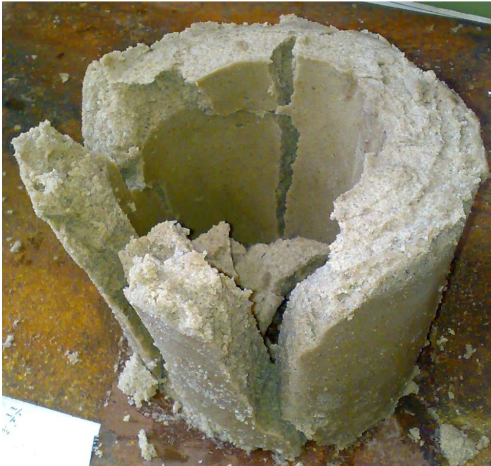
Рисунок 3.15 – Зруйнований КГЕ після 30 хв на повітрі при температурі 17°C і 30 хв у воді при початковій температурі 17°C, концентрація желатину 10%
