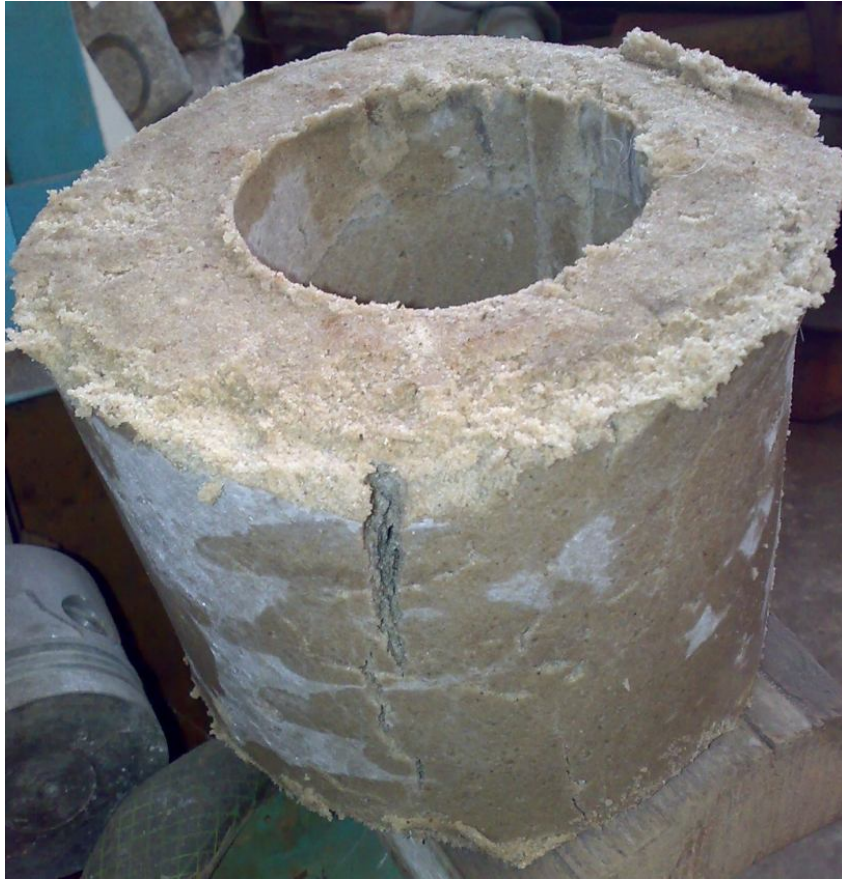
Рисунок 3.10 - Зразок після 30 хв на повітрі при температурі 17°C після руйнування при концентрація желатину 15%
