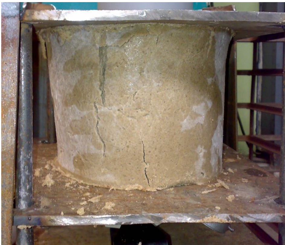
Рисунок 3.9 – Процес руйнування КГЕ з 15%-ою концентрацією желатину. Зразок після 30 хв розтеплення на повітрі
