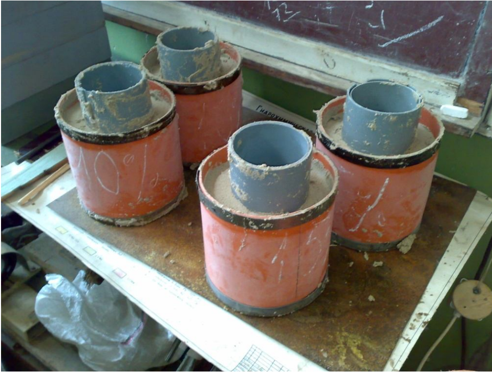
Рисунок 3.6 - Зразки КГЕ з 10% і 15%-ою концентрацією желатину у формах після заморожування
