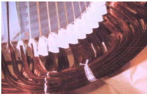
Рисунок 3.1 – Виконання трифазної розподіленої обмотки статора
