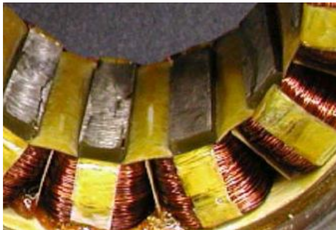
Рисунок 3.2 – Виконання трьохфазної зосередженої обмотки
