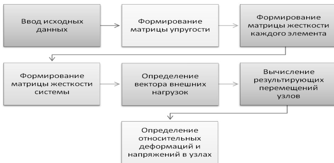
Рисунок 4 – Этапы расчета математической модели методом конечных элементов
