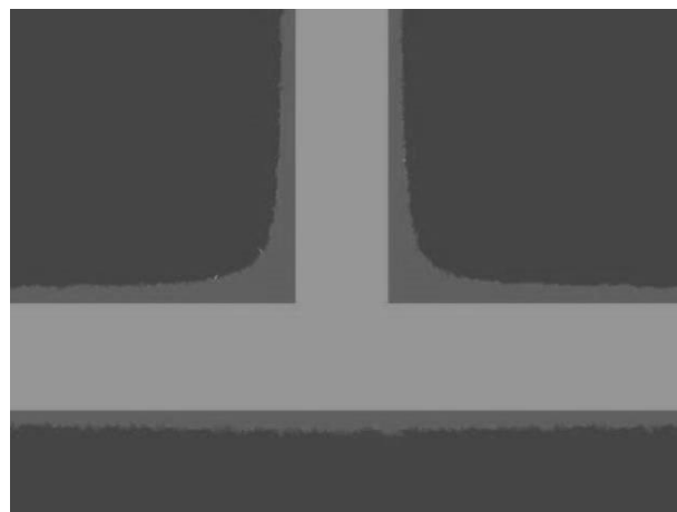
Рисунок 6 – Распределение коэффициента запаса прочности породного массива в окрестности сопряжения
