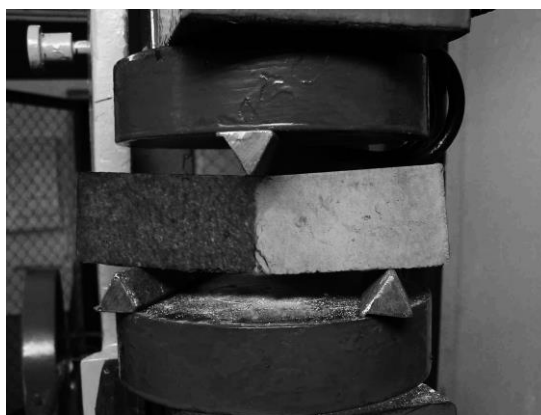
Рис.2. Испытание образцов-балочек на растяжение при изгибе.
