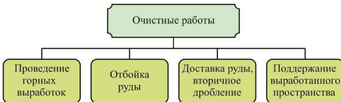
Рис. 3.1. Классификация комплекса рабочих процессов при производственной стадии очистных работ
