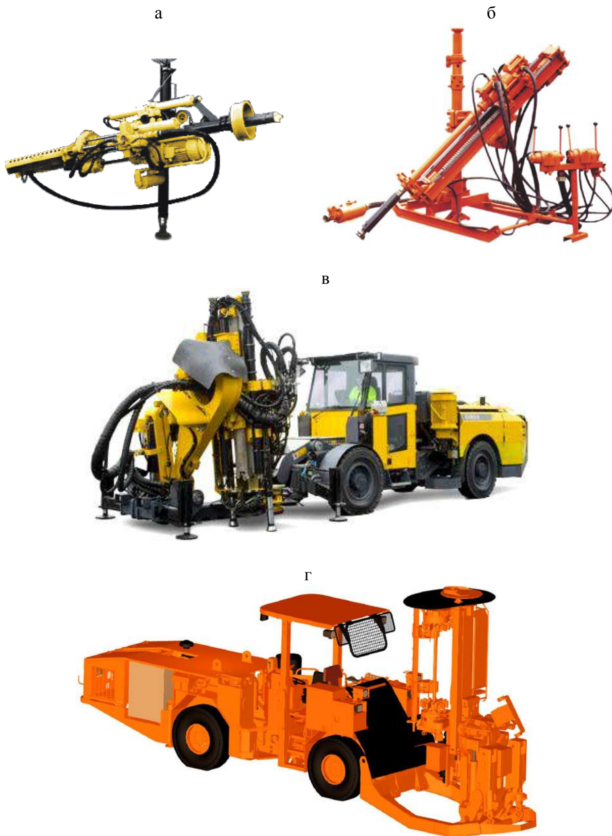
Рис. 2.31. Внешний вид буровых станков: а – НКР-100МПА; б – СТО-100; в – Simba L6C; г – DL320
