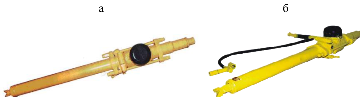
Рис. 2.6. Внешний вид телескопных перфораторов: а – ПТ-38Б; б – ПТ-48А
