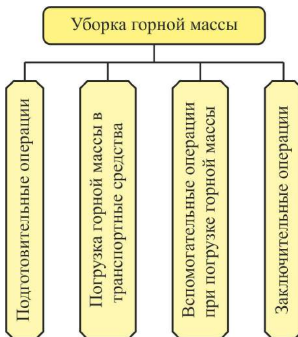
Рис. 2.15. Классификация операций при рабочем процессе уборки горной массы в забое
