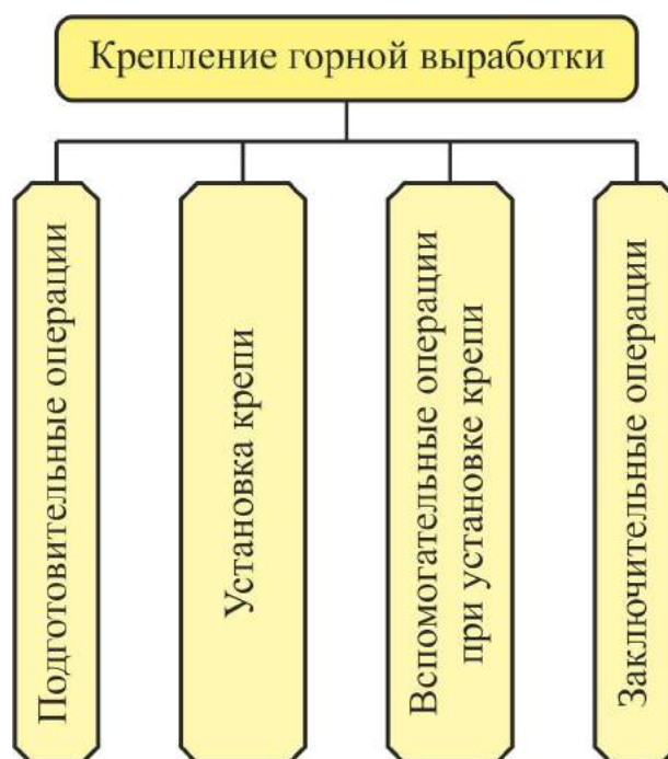
Рис. 2.20. Классификация операций в рабочем процессе крепления горной выработки
