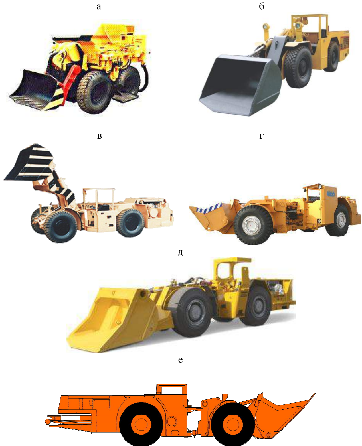
Рис. 2.18. Внешний вид транспортно-доставочных погрузочных машин: а – ПТ-4; б – ПД-2Э; в – ПД-5А; г – МоАЗ-4055; д – ST3,5; е – LH409E
