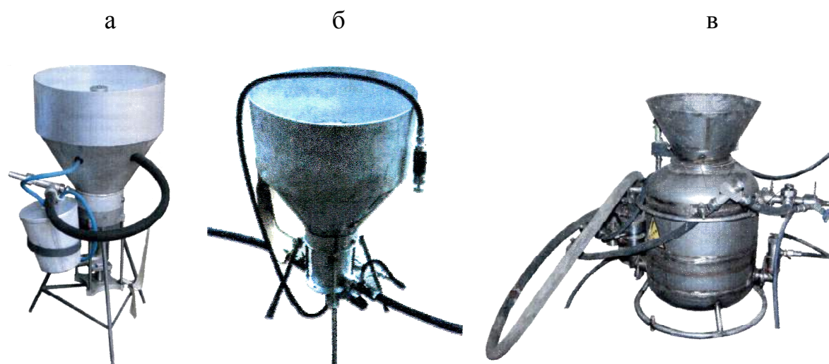
Рис. 2.9. Внешний вид пневматических зарядчиков для механизированного заряжания шпуров: а – УЗП-2; б – УЗП-3; в – МЗП-1
