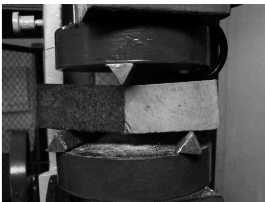
Рис.2. Испытание образцов-балочек на растяжение при изгибе.
