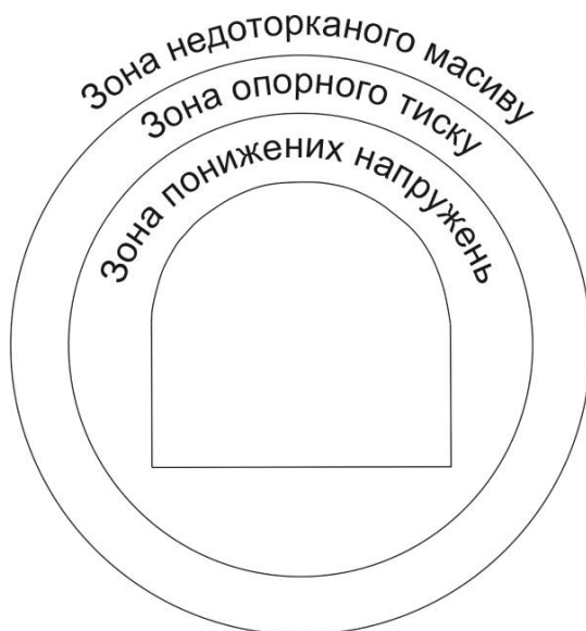
Рис. 8.5. Схема утворення зон напруженого стану при нестійкому стані бокових порід
