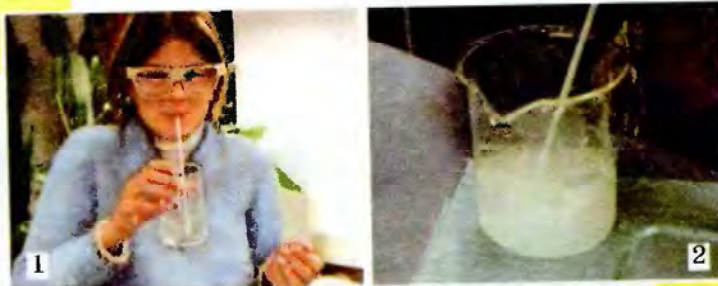
Рис. 5. Действие углекислого газа на известковую воду
