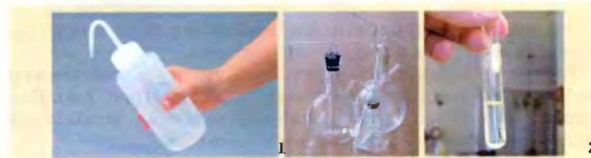
Рис. 2.4. 1. Промывалки используют для промывания осадков, ополаскивания посуды, доливания жидкостей малыми дозами до определенного объема. 2. Перемешивание жидкости и твердого вещества в пробирке
