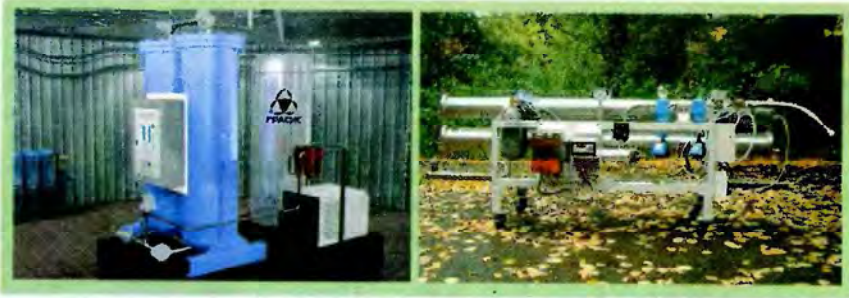
Рис. 18.1. Промышленные установки разделения газов воздуха
