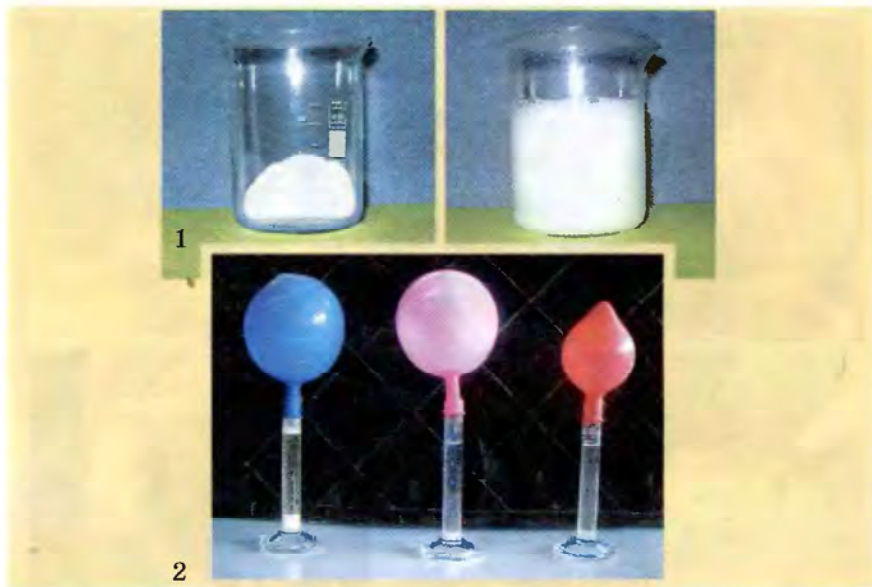
Рис. 2.8. 1. Смешивание пищевой соды с уксусом. 2. Опыт с воздушными шариками
