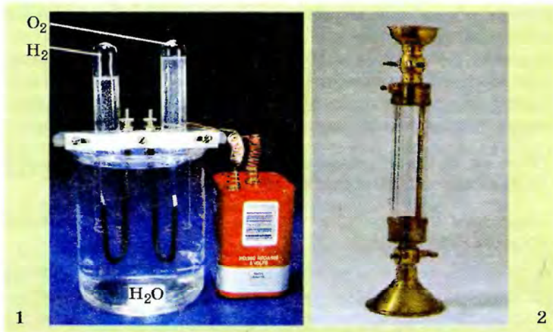
Рис. 15.4. 1. Прибор для разложения воды электрическим током. 2. Эвдиометр (в буквальном переводе с греческого – «измеритель добротности») – прибор для анализа воздуха
