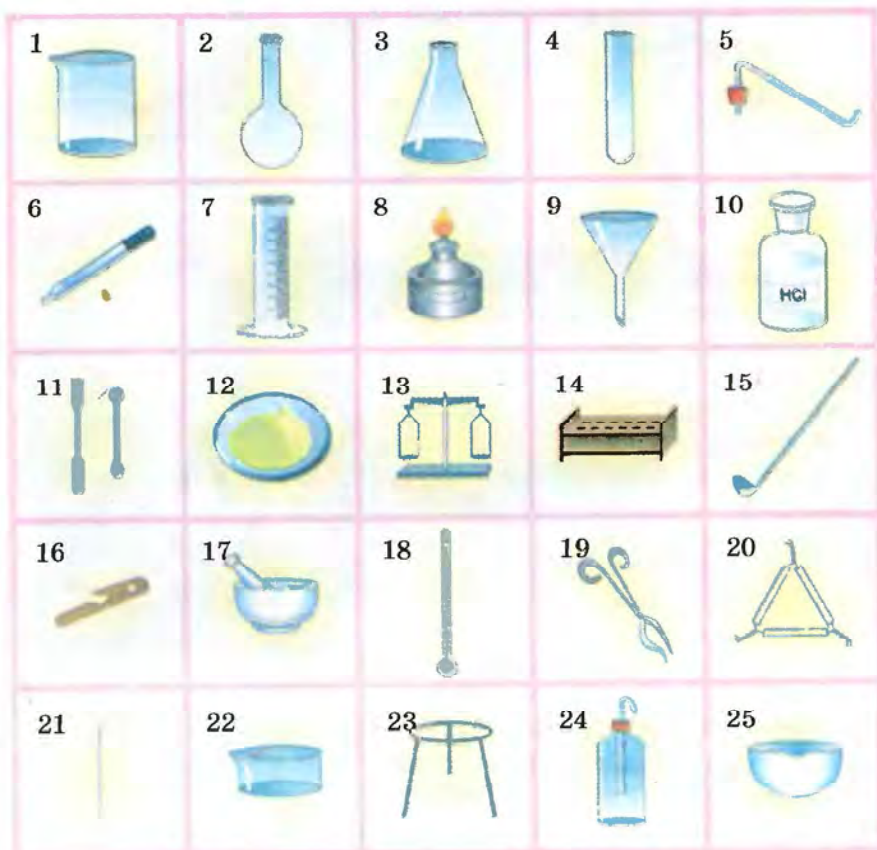
Рис. 2.10. 1 – химический стакан, 2 – круглодонная колба, 3 – коническая колба, 4 – пробирка, 5 – пробка с газоотводной трубкой, 6 – пипетка, 7 – мерный цилиндр, 8 – спиртовая горелка, 9 – воронка, 10 – стеклянная банка для хранения реактивов, 11 – шпатели, 12 – стеклышко, 13 – весы, 14 – штатив для пробирок, 15 – ложка для сжигания веществ, 16 – держатель для пробирок, 17 – ступка с пестиком, 18 – термометр, 19 – тигельные щипцы, 20 – фарфоровый треугольник, 21 – стеклянная палочка, 22 – кристаллизатор, 23 – треножник, 24 – промывалка, 25 – фарфоровая чашка
