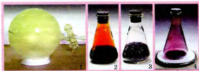
Рис. 11.4. Примеры неметаллов: 1 – емкость с \text{Cl}_2 ; 2 – \text{Br}_2 ; 3 – \text{I}_2 ; 4 – сублимация йода
