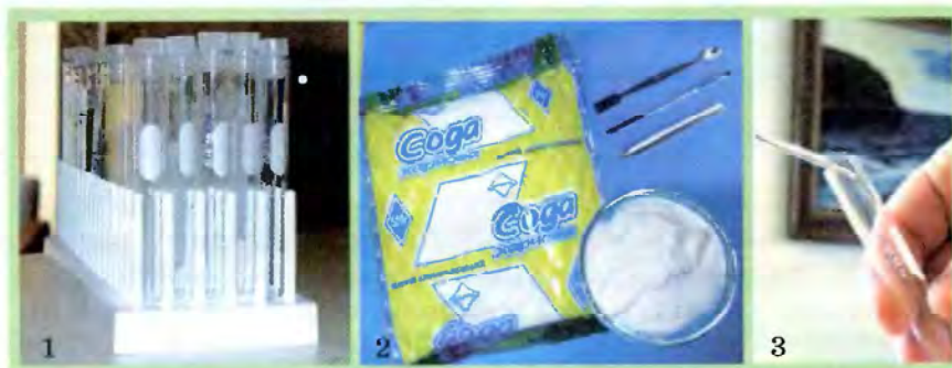
Рис. 2.3. 1. Штатив с пробирками. 2. Пищевая (пищевая) сода, шпатели. 3. Отбор пищевой соды в пробирку шпателем
