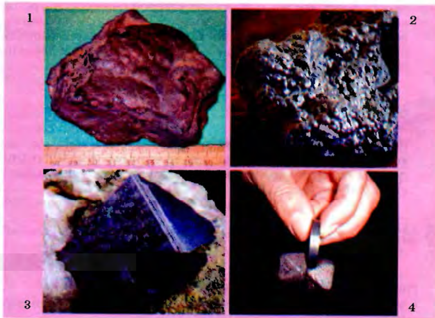
Рис. 21.5. 1–3. Образцы магнетита. 4. Физические свойства магнетита
