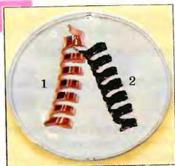
Рис. 3. Медная спираль до (1) и после (2) прокаливания
