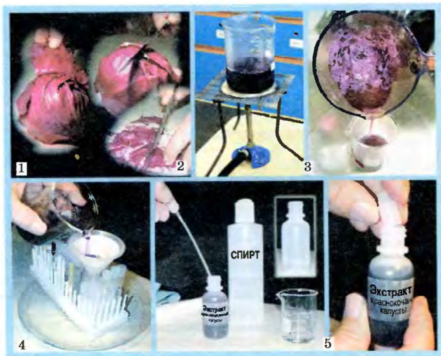
Рис. 2.6. 1. Краснокочанная капуста. 2. Измельчение. 3. Изготовление отвара. 4. Фильтрование отвара. 5. Добавление пипеткой спирта
