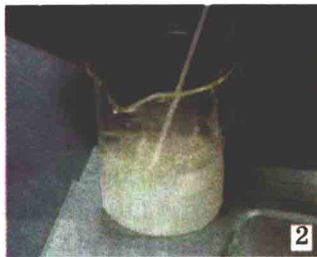
Мал. 5. Дія вуглекислого газу на вапняну воду
