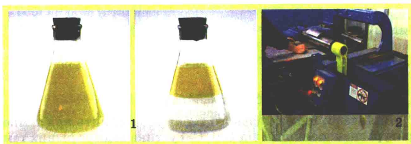
Мал. 14.2. 1. Олія нерозчинна у воді і легша за неї. Через певний час після перемішування цих рідин олія спливає на поверхню. 2. Магній пластичний. Його обробляють прокатуванням
