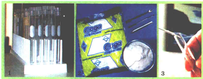
Мал. 2.3. 1. Штатив з пробірками. 2. Питна (харчова) сода. 3. Відбір питної соди в пробірку шпательом
