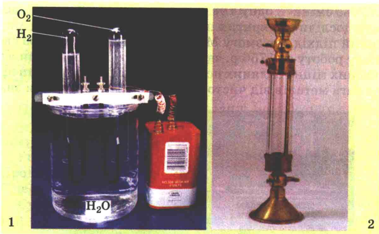
Мал. 15.4. 1. Прилад для розкладання води електричним струмом. 2. Евдіометр (у буквальному перекладі з грецької – «вимірник добротності») – прилад для аналізу повітря
