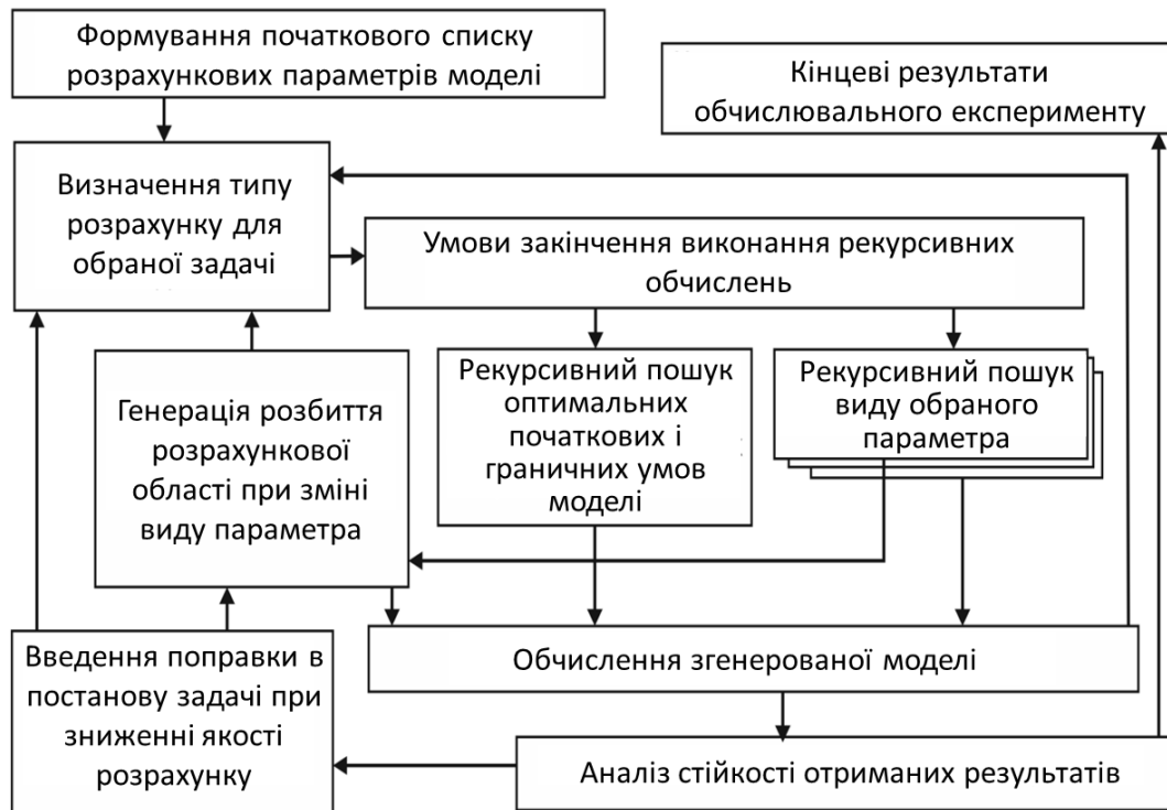
Рисунок 1 – Узагальнений алгоритм реалізації багатопараметричної рекурсивної нелінійної моделі розрахунку геомеханічного об'єкта при формуванні обчислювальної області чисельного методу
