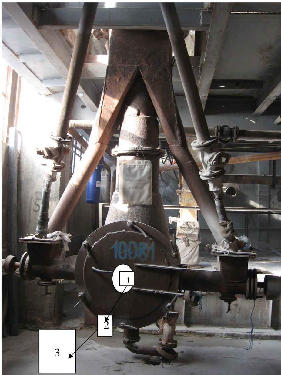
Рисунок 3 – Установка акустической аппаратуры на промышленной струйной мельнице
