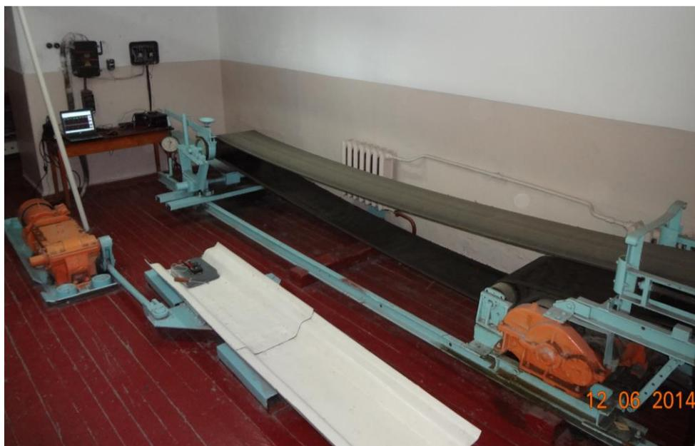
Рисунок 3.7 – Испытательный стенд конвейерной установки с замкнутым тяговым органом
