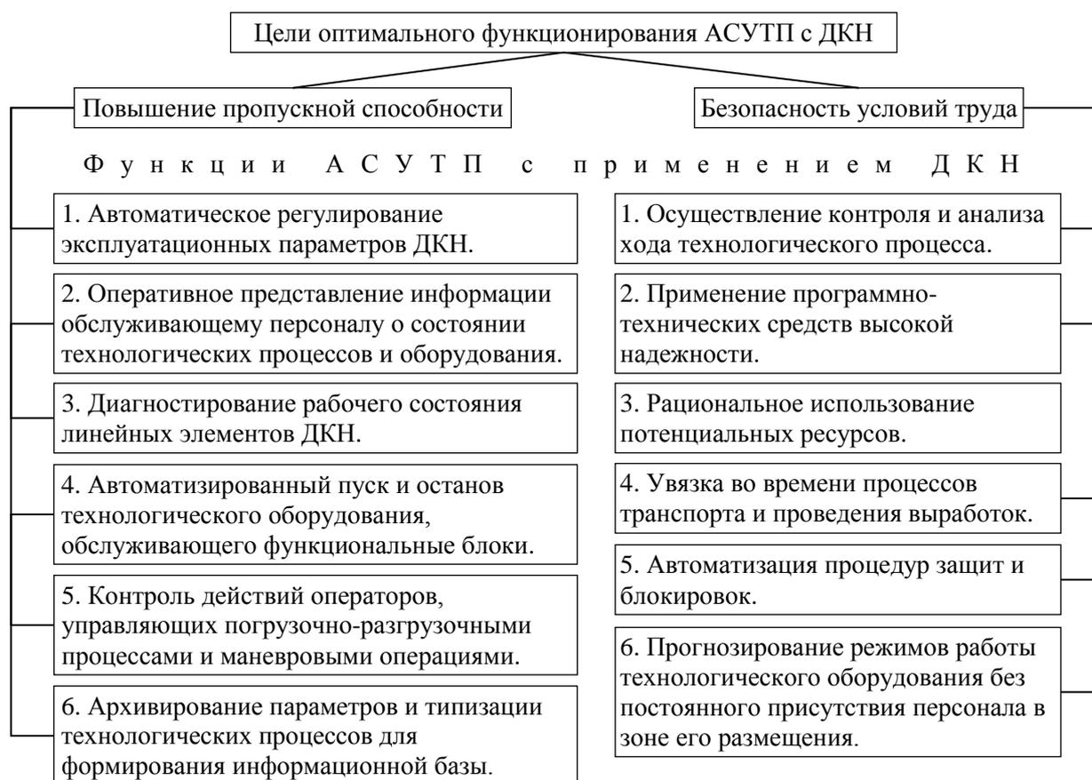
Рисунок 4.2 – Структурная схема функций АСУТП с применением ДКН
