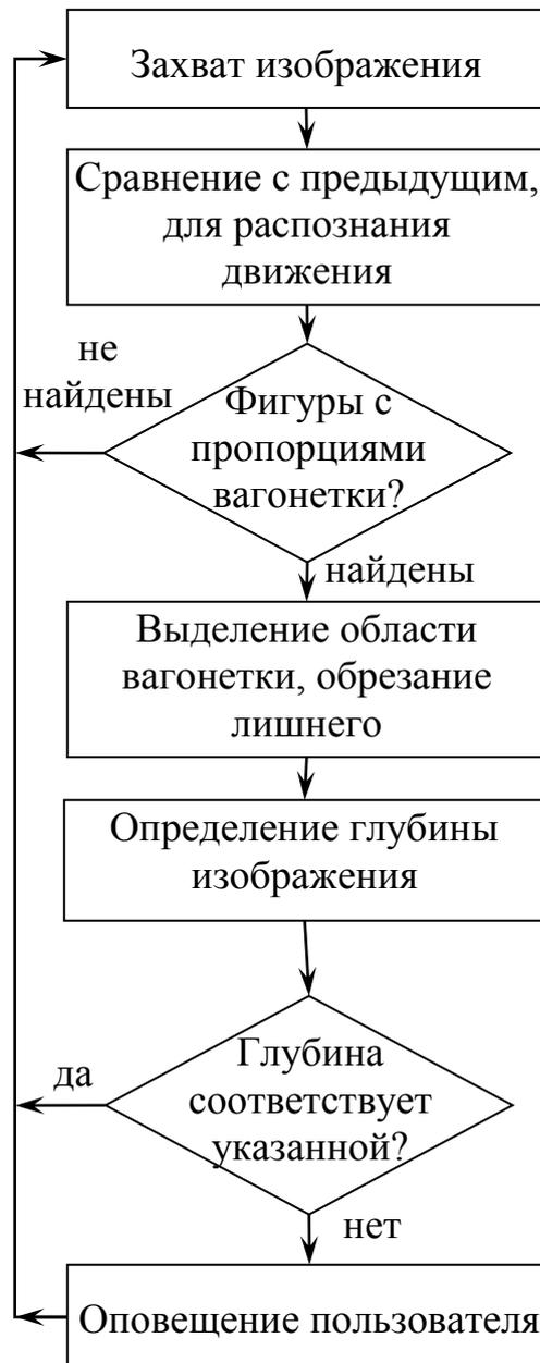
Рисунок 4.9 – Алгоритм работы системы диагностики
