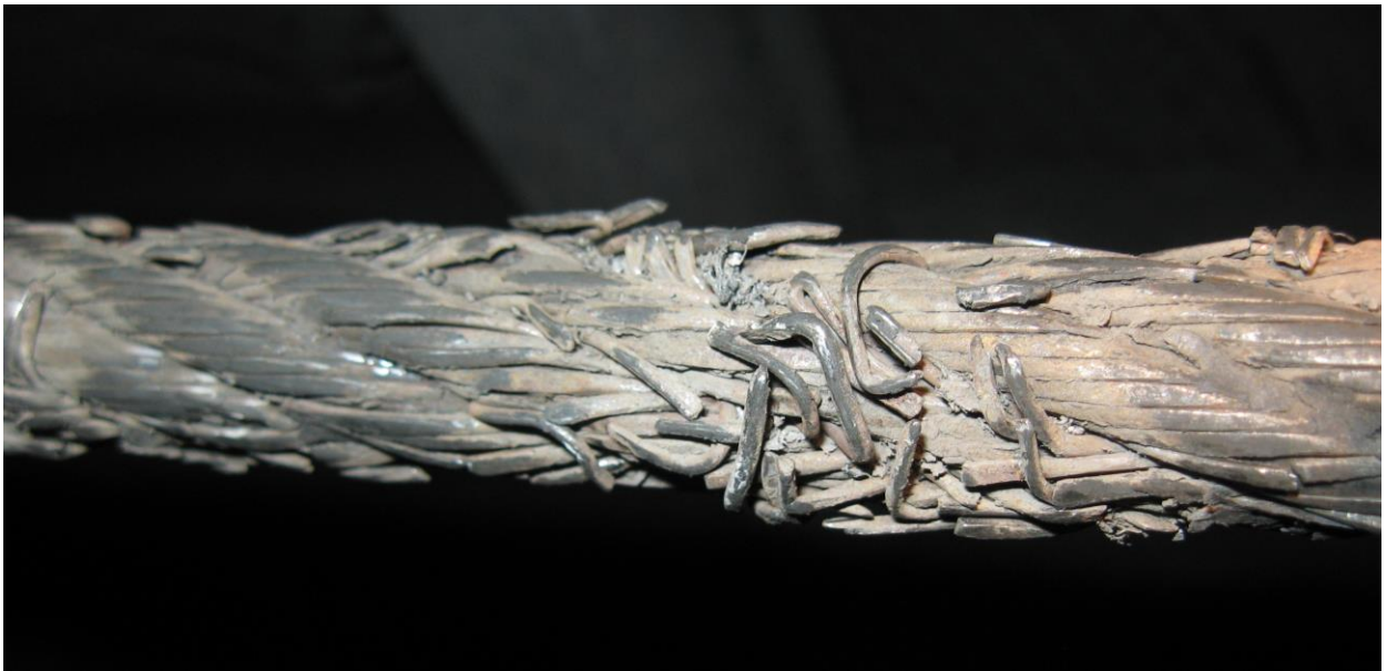
Рисунок 6.1 – Фрагменты износа тягового органа ДКН в процессе эксплуатации
