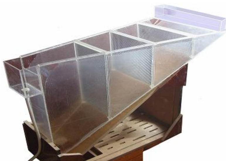
Рис. 3.2. Действующий макет отстойника масштабом 1:20 (далее макет)
