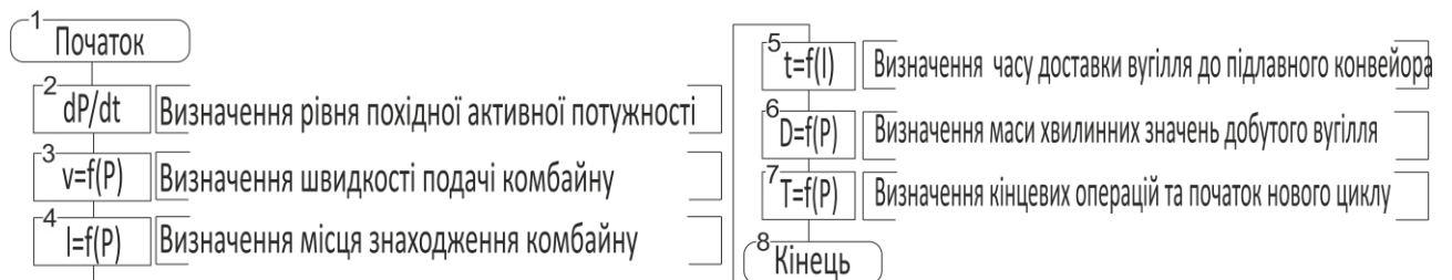
Рисунок 2. Алгоритм визначення хвилинних значень вантажопотоку з очисного вибою
