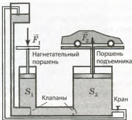
Рис. 23.8. Гидравлический подъемник — пример гидравлической машины
