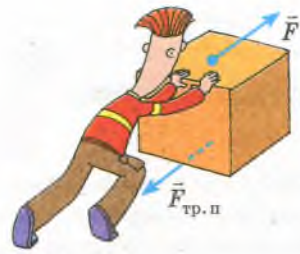
Рис. 21.1. Не удастся сдвинуть ящик с места — мешает сила трения покоя ( \vec{F}_{\text{тр. п}} )
