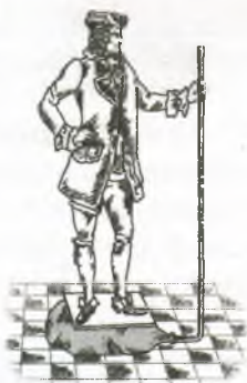
Рис. 24.1. Сила давления воды в кожаной подушке достаточна, чтобы удерживать взрослого человека
