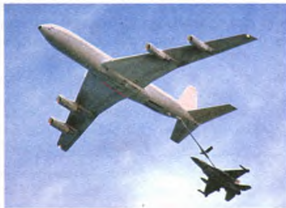
i Рис. 6.5. Заправка самолета в воздухе: самолеты находятся в состоянии покоя относительно друг друга
