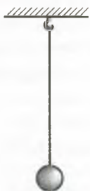
Рис. 13.4. Металлический шарик на длинной нерастяжимой нити достаточно удобен для изучения основных свойств колебаний
