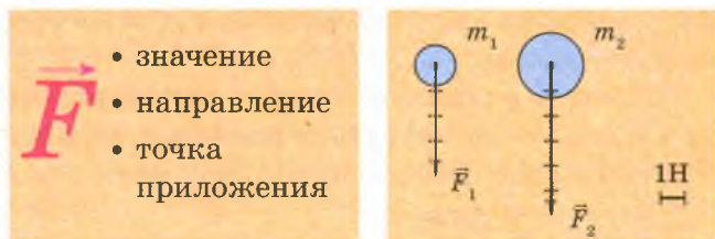
Рис. 18.3. Со стороны Земли на тело массой m_1 = 400 г действует сила F_1 = 4 Н, на тело массой m_2 = 600 г действует сила F_2 = 6 Н. Длины стрелок, изображающих эти силы, в определенном масштабе равны значениям сил
