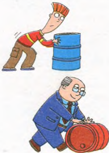
Рис. 21.9. Замена скольжения на качение приводит к уменьшению силы трения
