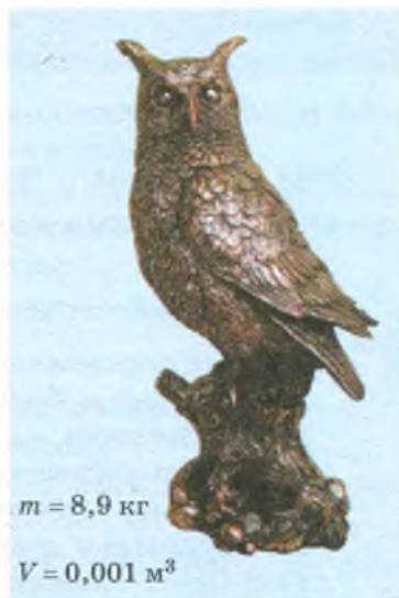
Рис. 16.5. Плотность вещества, из которого изготовлена однородная фигурка, равна 8900 \text{ кг/м}^3 . Вероятно, фигурка изготовлена из меди
