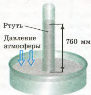
Рис. 25.4. Модель трубки Торричелли: высота h столба ртути в трубке всегда около 760 мм
