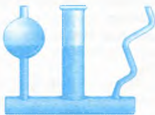
Рис. 26.2. Независимо от формы открытых сообщающихся сосудов уровень жидкости в них одинаковый
