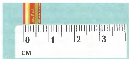
Рис. 5.3. Измерение толщины карандаша
